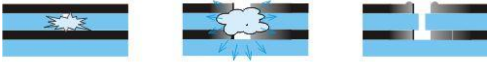
Şekil 2.1:Kondansatörün kendini onarması
