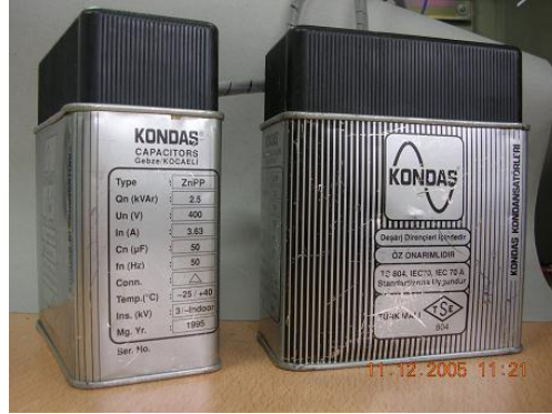
Resim 2.2: Deşarj dirençleri içerisinde olan 2,5 Kvar'lık bir kondansatör
